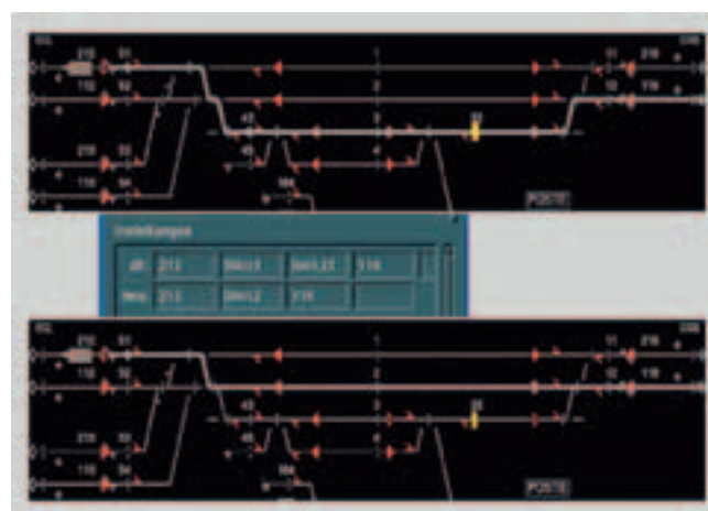
Рис. 6. Обход места проведения путевых работ при помощи макроса маршрутов
