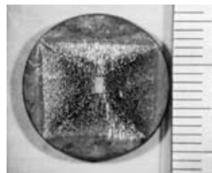
Рис. 3. Вид образца из сверхпроводящего материала типа Sm123
