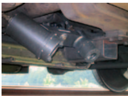
Рис. 3. Устройство Laserail 3000 корпорации ImageMap, смонтированное на тележке вагона-путеизмерителя
