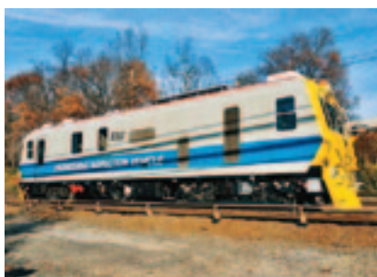
Рис. 5. Путееизмерительный вагон EM 160 корпорации Plasser American
