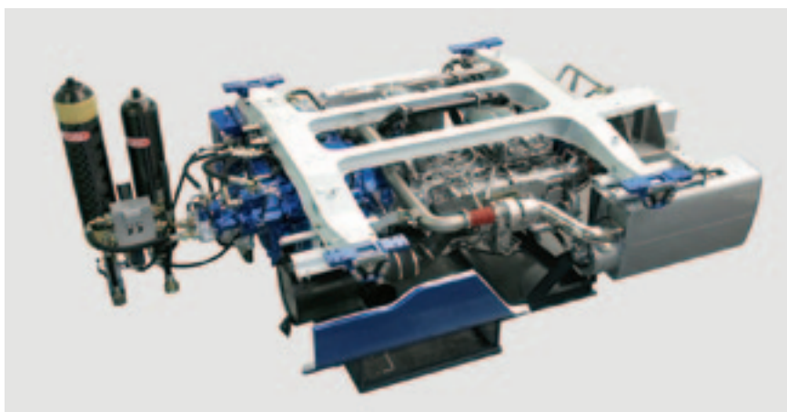
Рис. 3. Компактный силовой агрегат EcoPack
