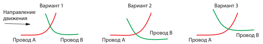
Рис. 10. Варианты исполнения мест сопряжения секций контактной подвески
