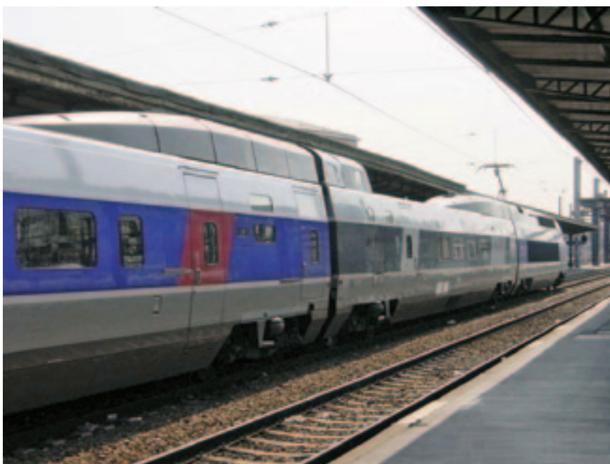
Рис. 2. Инспекционный вагон типа Mélusine в составе высокоскоростного поезда
