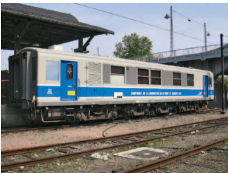
Рис. 1. Инспекционный вагон типа Mauzin
