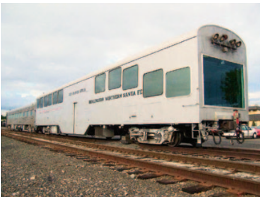
Один из вагонов-путьеизмерителей железнодорожной компании BNSF
