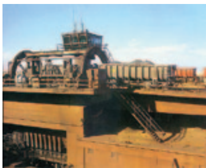
Рис. 1. Выгрузка руды из вагонов в порту Нуадибу с помощью вагоноопрокидывателя
