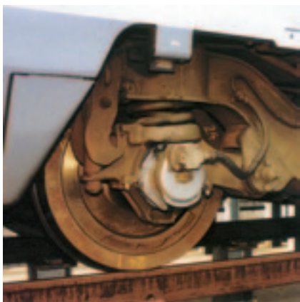
Рис. 2. Колесо поезда TGV с оптимизированным ободом
