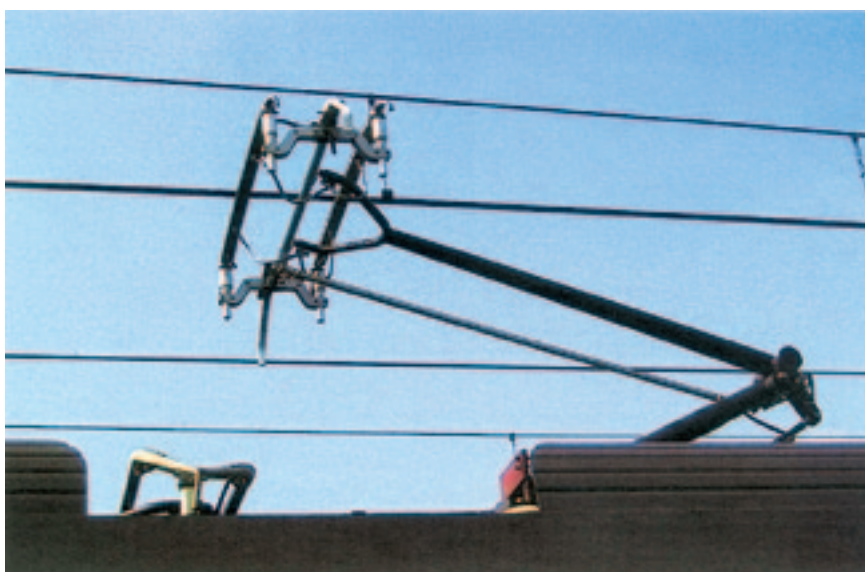
Рис. 10. Токоприемник поезда TGV POS
