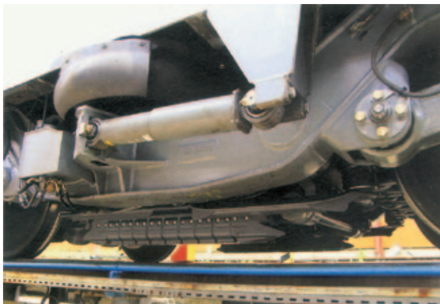
Рис. 9. Поддерживающая тележка с башмаками магниторельсового тормоза
