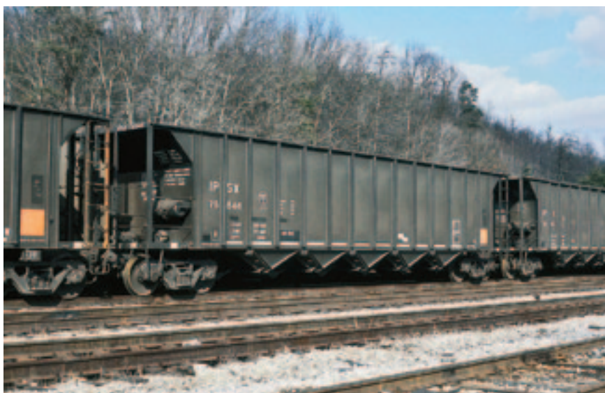
Хопперы с внутренним покрытием, обеспечивающим быструю выгрузку сыпучих материалов
