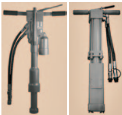
Рис. 5. Станки для постановки (типа 910095, слева) и выдергивания (типа 910097, справа) костылей
