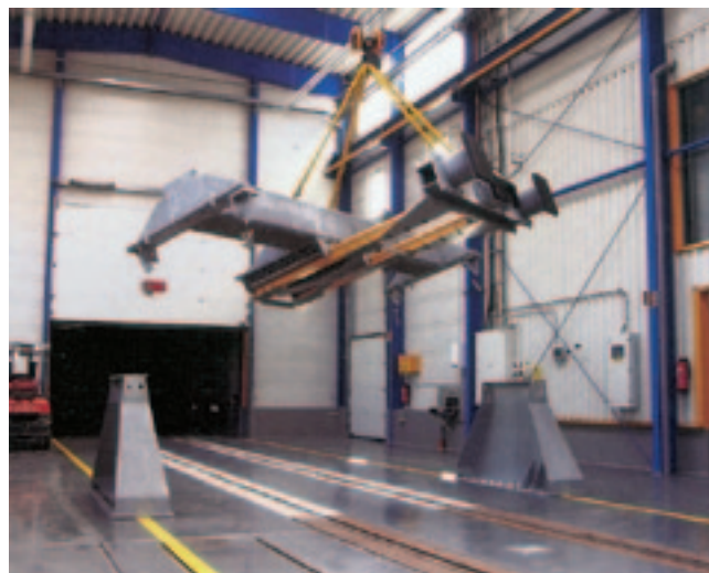
Рис. 3. Тупиковый упор со снятой несущей балкой и буферным устройством
