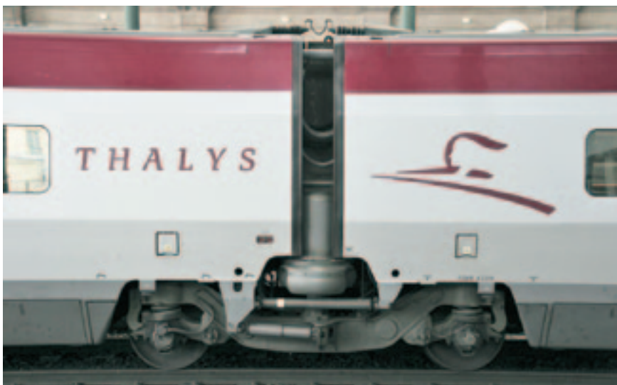
Рис. 3. Узел сочленения смежных вагонов и промежуточной тележки поезда Thalys
