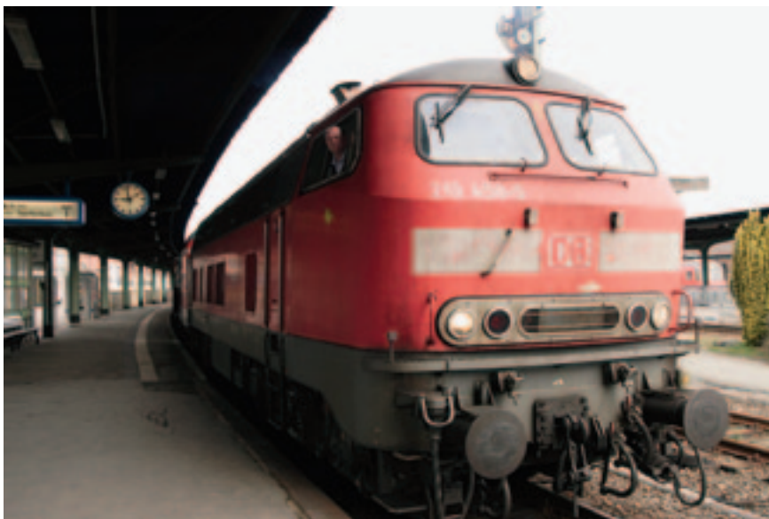
Тепловоз серии 218, получивший серийное обозначение 210 после дооборудования газовой турбиной
