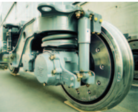
Рис. 3. Гаситель колебаний высокоскоростной тележки (фото: Siemens)
