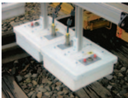
Рис. 2. Аппаратура системы SafeRailSystem на вагоне EM-SAT: слева — общий вид; в центре — георадарные антенны; справа — пульт управления
