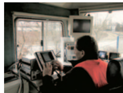
Рис. 2. Аппаратура системы SafeRailSystem на вагоне EM-SAT: слева — общий вид; в центре — георадарные антенны; справа — пульт управления
