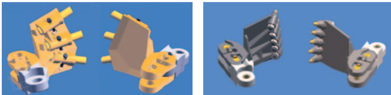
Рис. 4. Детали баровой цепи, выполненные с возможностью быстрой замены
