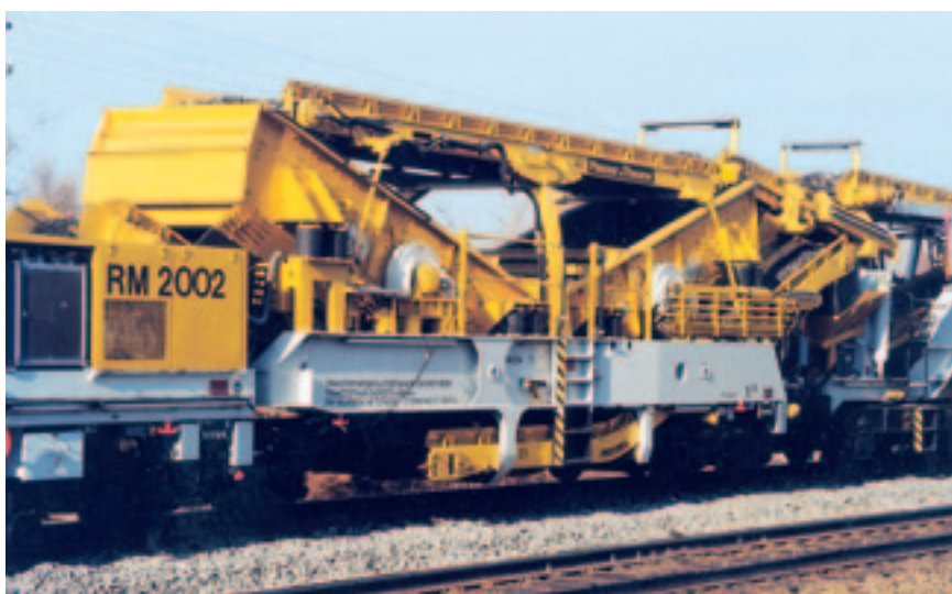
Рис. 6. Сдвоенный блок сортировки (машина RM 2002, фото: Plasser & Theurer)
