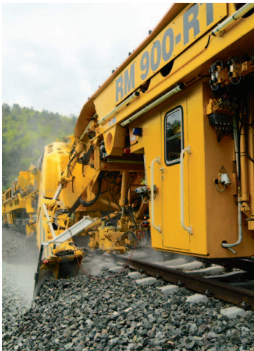
Рис. 1. Блок вырезки балласта в работе (машина типа RM 900, фото: Plasser & Theurer)
