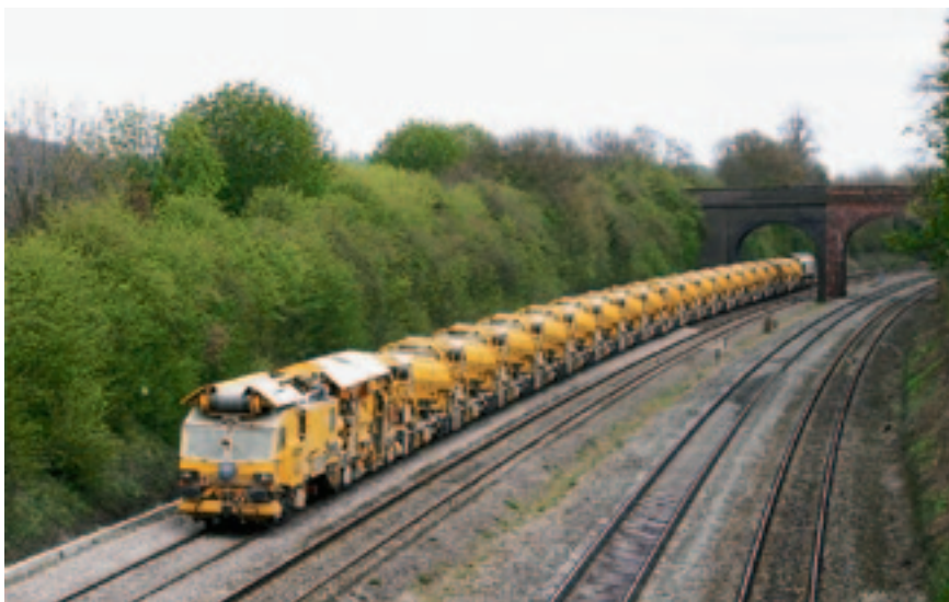
Рис. 12. Состав из хопперно-конвейерных модулей типа MFS 80
