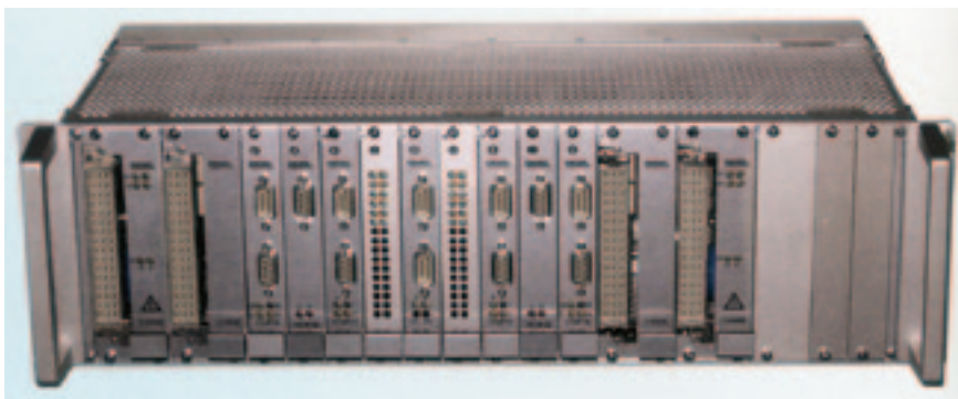
Рис. 5. Специализированный модуль передачи STM для локомотивной сигнализации АТВ
