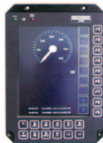
Рис. 4. Прибор индикации, основанный на стандартах ETCS, для поездов TGV POS и Thalys
