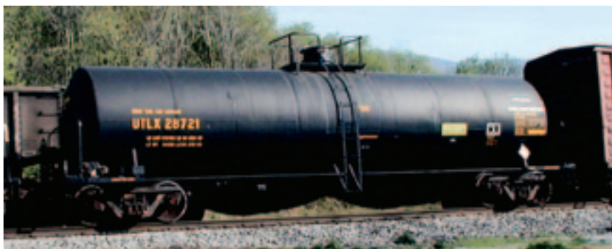
Рис. 3. Цистерна компании Union Tank Car для перевозки хлора
