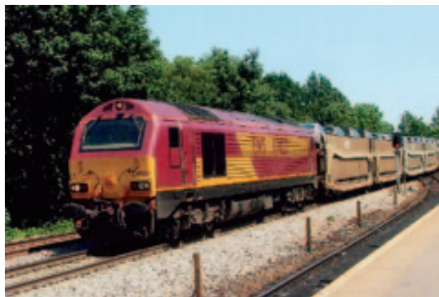
Рис. 3. Тепловоз серии 67 компании EWS с ускоренным грузовым поездом для перевозки автомобилей
