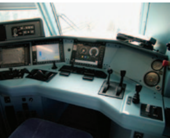
Рис. 5. Пульт управления электровоза Re 484
