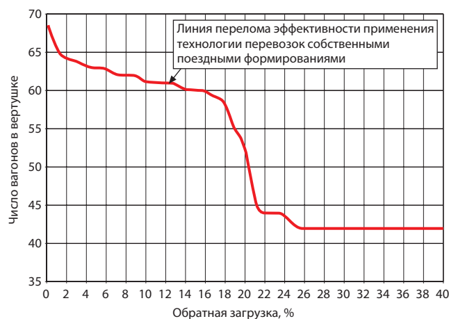
Рис. 8. График разделения областей эффективного применения конкурирующих технологий перевозок с учетом обратной загрузки
