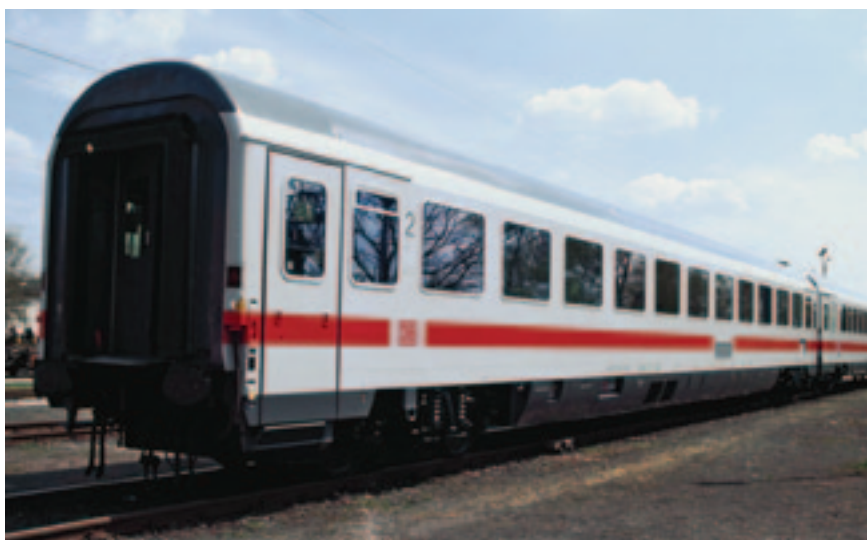
Рис. 3. Комбинированный вагон второго класса серии Bvmz с купе и общим салоном (фото: DBAG, Вебер)
