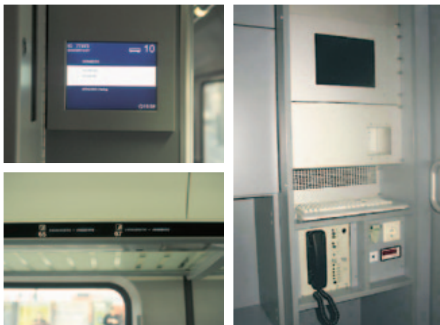
Рис. 6. Система информирования пассажиров (FIS): панель системы FIS в вагоне серии Bpmz (фото слева сверху), указатель резервирования мест в вагоне Bpmz (фото слева внизу) и центральный компьютер системы FIS в вагоне серии Bvmsz (фото справа)
