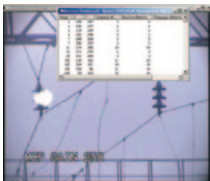
Рис. 15. Фрагмент процесса автоматического распознавания и диагностирования изоляторов контактной сети с помощью программы UFAnalyser
