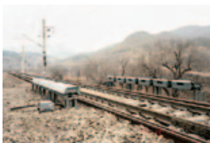
Рис. 4. Акустическая система для оценки состояния буксовых подшипников
