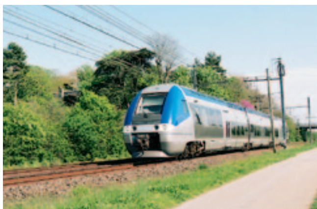
Рис. 2. Моторвагонные поезда семейства AGC: слева — в варианте электропоезда; справа — в варианте дизель-поезда
