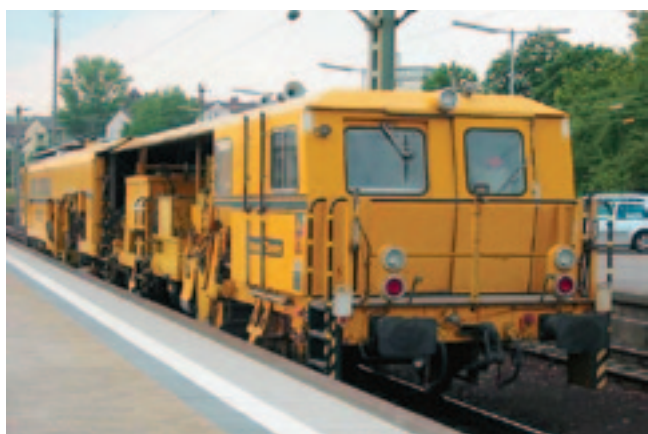
Рис. 5. Машина UNIMAT 08-475/4S
