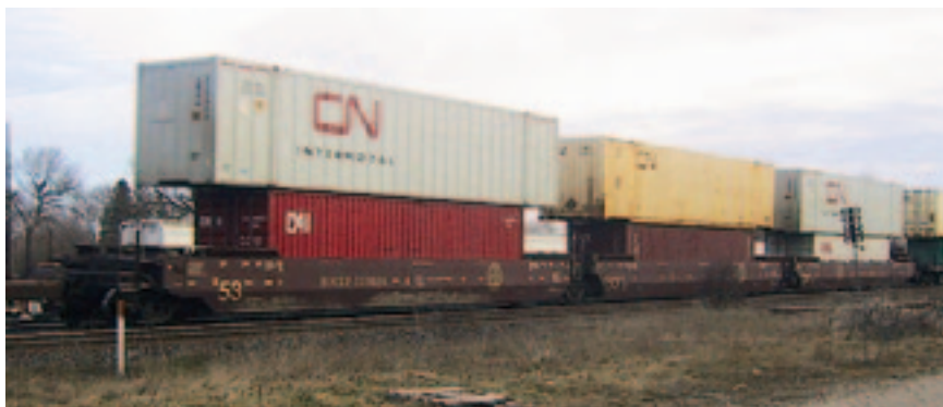
Рис. 2. Вагон-платформа для погрузки контейнеров в два яруса компании Gunderson (США)
