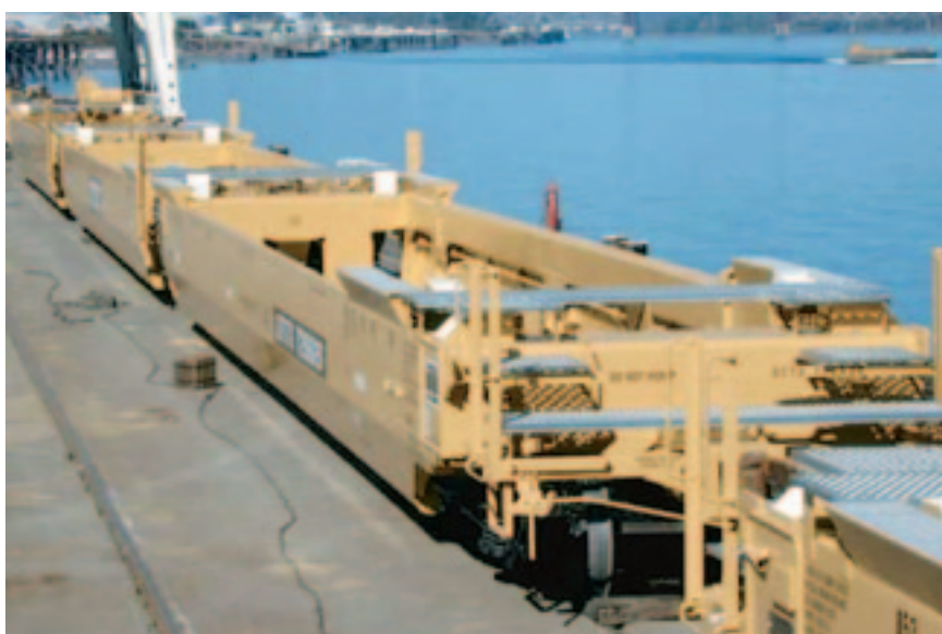
Рис. 2. Вагон-платформа для погрузки контейнеров в два яруса компании Gunderson (США)
