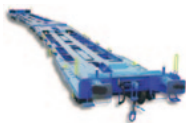
Рис. 5. Сочлененная платформа Megafret Twin FCA
