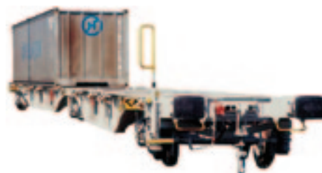
Рис. 7. Сочлененная платформа компании Trinity Rail Europe
