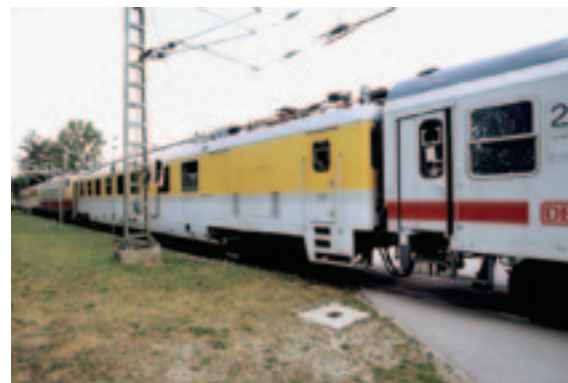
Рис. 3. Измерительный поезд на участке между станциями Донаувёрт и Аугсбург (фото: DBAG, Нильсен)
