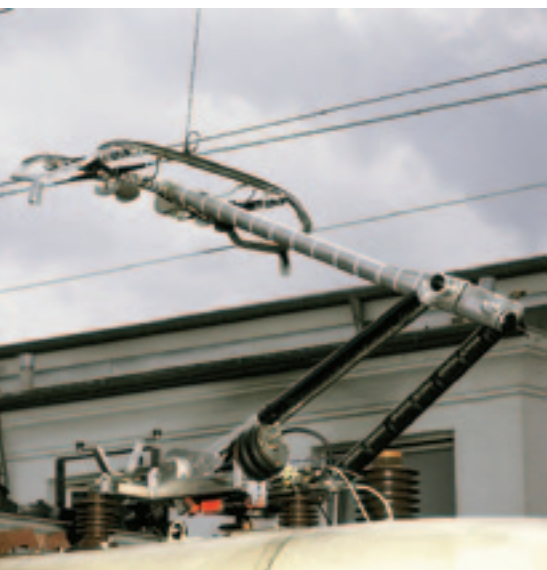
Рис. 1. Токоприемник ASP без обтекателя нижней рамы (фото: DBAG, Нильсен)
