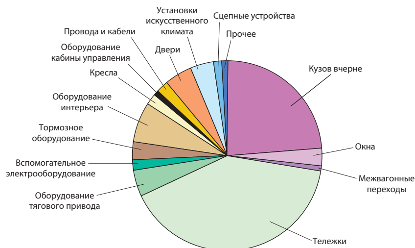
Рис. 7. Распределение массы вагона электропоезда по составляющим
