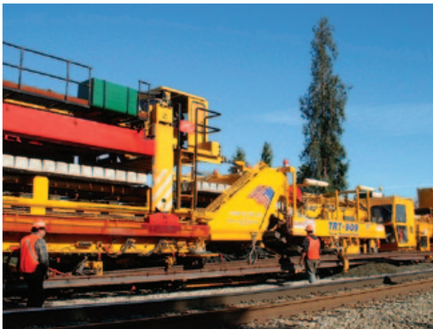
Рис. 4. Путеремонтный комплекс TRT909
