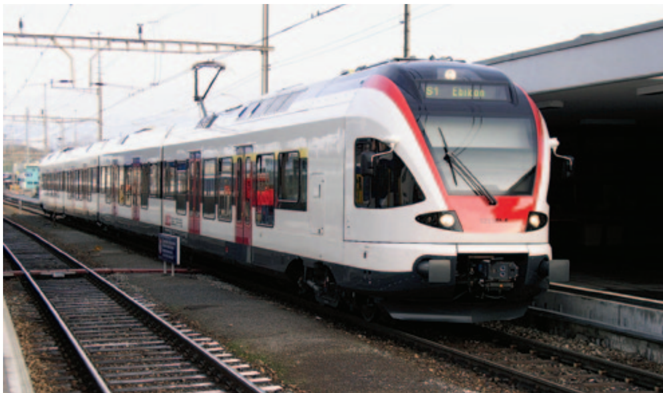
Рис. 1. Электропоезд FLIRT производства компании Stadler Rail
