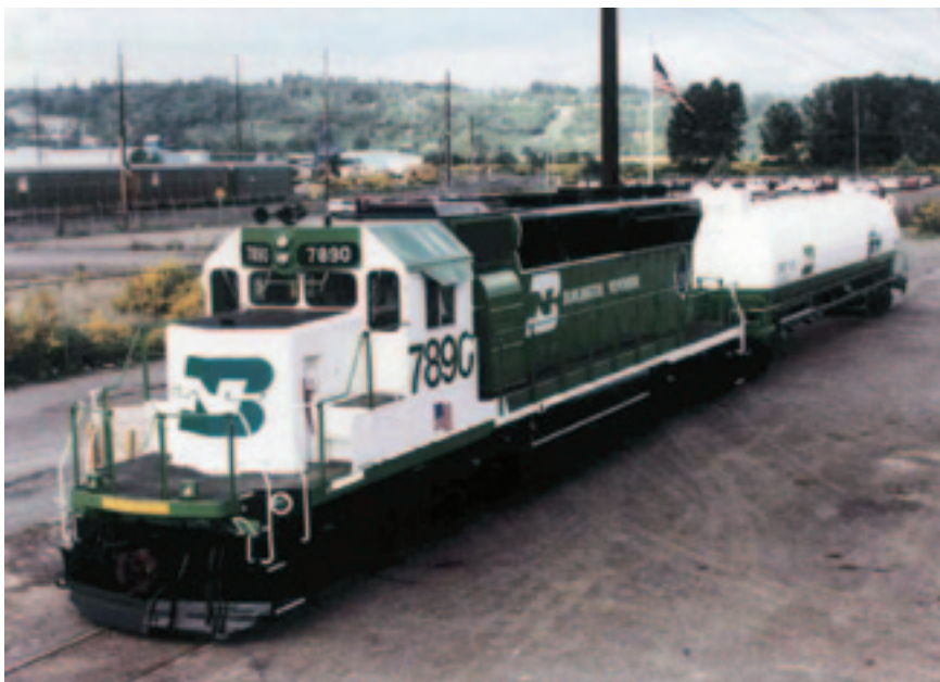
Рис. 5. Магистральный газотепловоз SD40-2 с криогенным тендером-цистерной железной дороги Burlington Northern (США)
