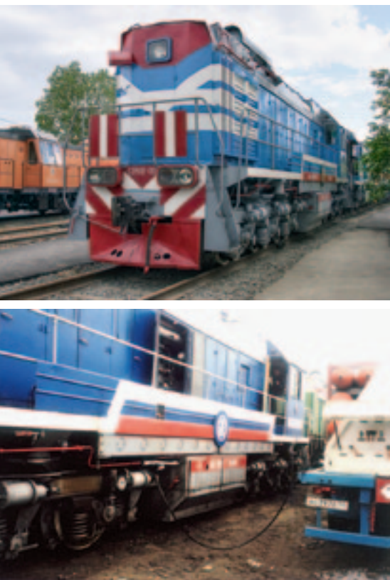
Рис. 2. Маневровый газотепловоз ТЭМ18Г и его заправка автогазозаправщиком
